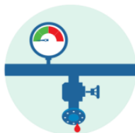
破管前物料“清空” 及能量“卸载”
